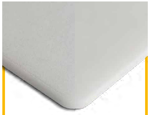
Trowalisiert 20 Minuten / 4 Stunden Selektives Lasersintern
