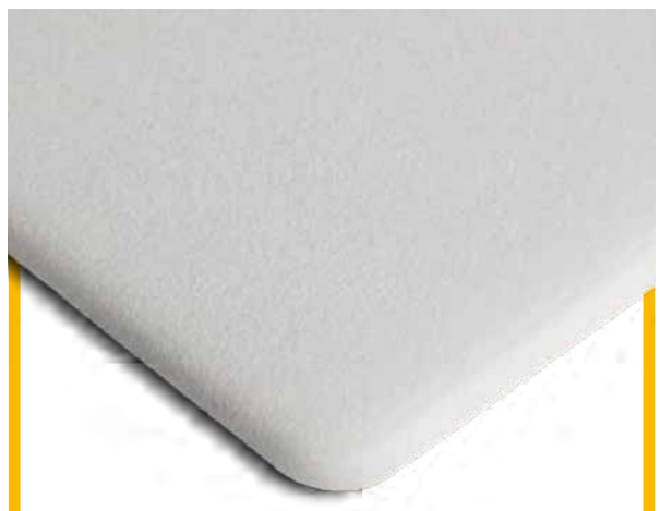
Glasperle gestrahlt Selektives Lasersintern
