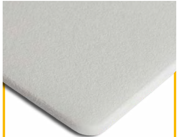
Verdichtet in Rapid Cleaner Selektives Lasersintern
