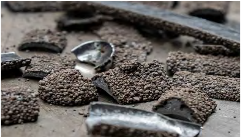
In einem aufwändigen Automatisierungs- und Hardwareentwicklungsprozess wird die Schlackekruste nach jeder vollendeten Bahn automatisch entfernt.
