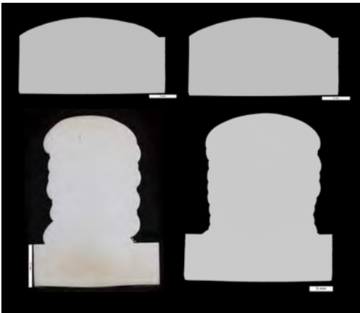
Schliffbilder von SAAM Schweißraupen (oben) und Wänden mit 10 Schichten (unten). Verwendung eines DC+ Parameters (links) und eines AC Parameters (rechts).
